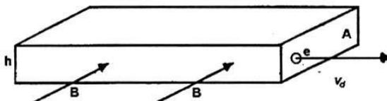
L'intensità di corrente è  $I$  ed è dovuta al moto di elettroni di conduzione (carica  $e = 1.6 \cdot 10^{-19}$  Coulomb) che si muovono da sinistra verso destra (in numero di  $n$  per metro cubo) con una velocità di deriva  $v_d$ .
