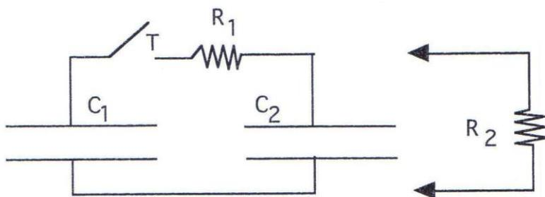
Inizialmente il tasto  $T$  è aperto come in figura ed entrambi i condensatori sono scarichi. Le due armature del condensatore  $C_1$  vengono, quindi, collegate ad una batteria di f.e.m.  $V_0 = 4,5 \text{ V}$ , in modo che il polo positivo della batteria risulti collegato con l'armatura superiore del condensatore  $C_1$ ; la batteria viene successivamente rimossa. Dopodiché il tasto  $T$  viene chiuso e si attende che il sistema raggiunga una condizione di equilibrio.
