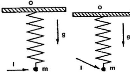
Si esercita sul punto materiale, in un tempo trascurabile, un impulso  $I$ , diretto orizzontalmente di modulo  $I = 1 \text{ Kg m/s}$ .
